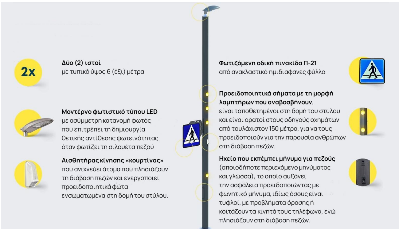
Εικόνα 12: Λειτουργικά συστατικά έξυπνης διάβασης πεζών
